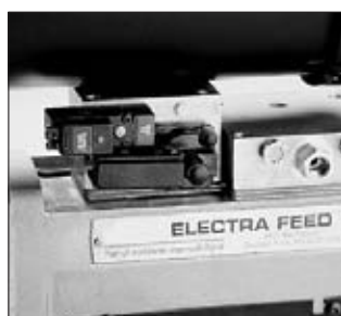
Solenoid-Satz - Teil-Nr. 49787 für Fernsteuerungsanschluß.
