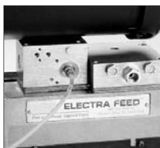
159764-004 Stecker und 59690-000 Kapillarschlauch.
