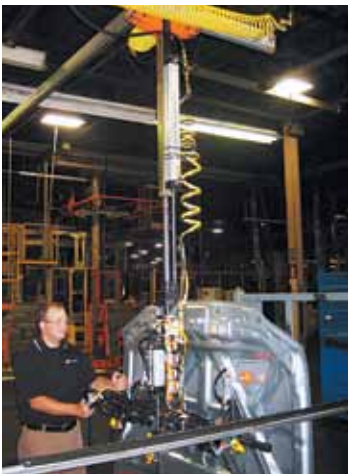
Drehmomentrohr mit integriertem Vakuum-Handhabungssystem
